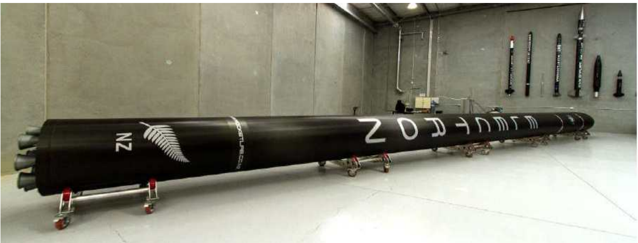
<Electron 발사체의 실제 형상, Rocket Lab(2017)>
